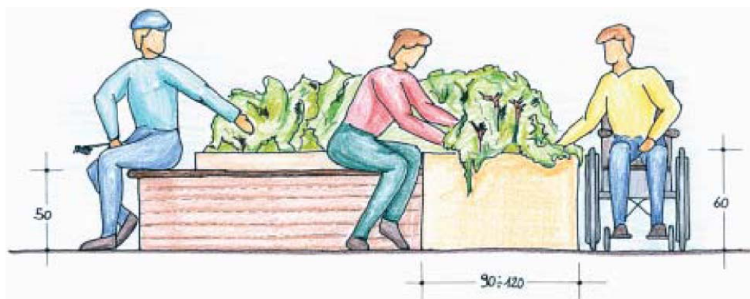
Coltivazioni accessibili attrezzate con sedute di lavoro.
